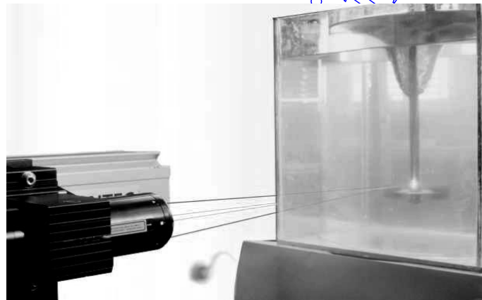
Fot. 4. Emiter systemu laserowego LDA firmy Dantec Fot. 4. Emitter of LDA Dantec laser system
