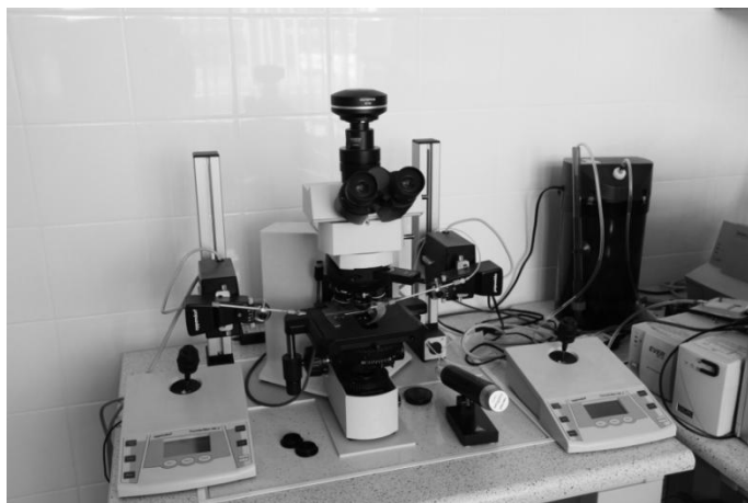
Fot. 5. Mikroskop badawczy z zestawem narzędzi do mikromanipulacji Fot. 5. Research microscope with tools for micromanipulation
