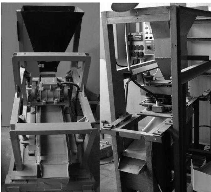
Fot. 3. Przesiewacz laboratoryjny o regulowanych parametrach procesowych Fot. 3. Set of laboratory screening with controlled process parameters
